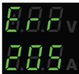
L'exemple présenté dans l'image de gauche indique un défaut de tension d'alimentation du générateur.
