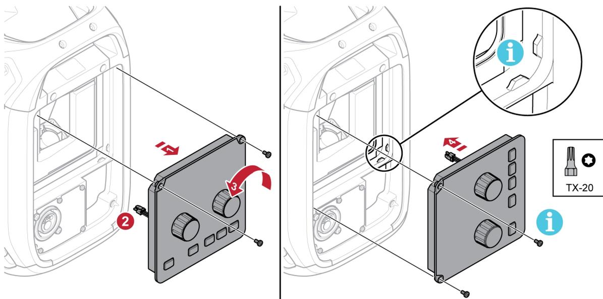
1) Déposez les deux vis du panneau de commande et déposez le panneau.
